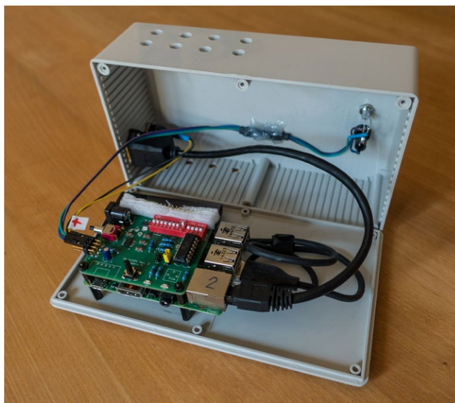
Musikserver, Innenleben (mit iSwitchPi stacked auf dem Pi)
